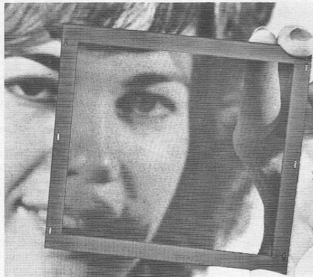
De grote gaatjesdichtheid maakt dit cellenplaatje vrijwel doorzichtig. Het is vervaardigd van een UV-gevoelige glassoort, „Fotoform B” genaamd. Dergelijke plaatjes worden toegepast in visualiseringsorganen voor cijfers en/of letters die werken volgens het gasontladingsprincipe.
